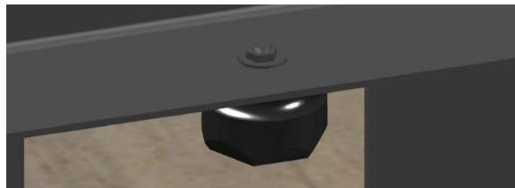
Imagen N° 40. Ensamblaje Troquel en Estructura Principal
