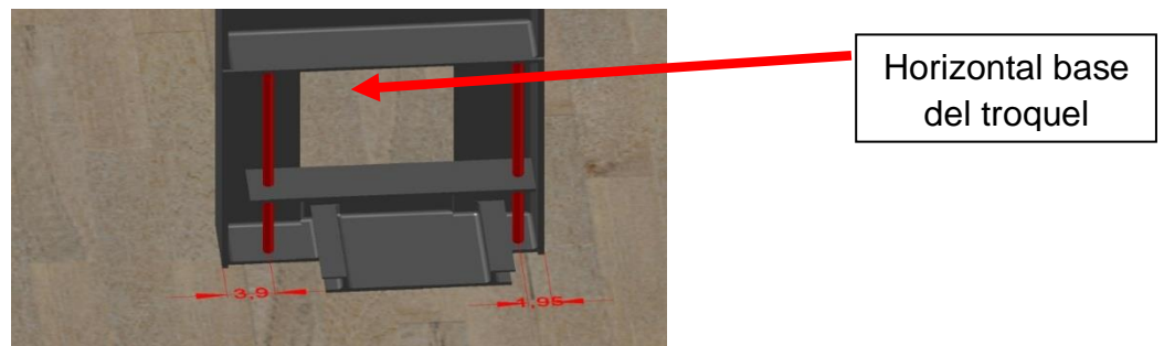
Imagen N° 24. Colocación de cabillas y placa de hierro 5 cm x 23,5 cm
