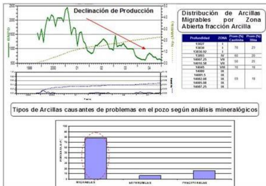
Figura 8. Comportamiento de Producción y tipos de arcillas presentes. Pozo AZ-1.
