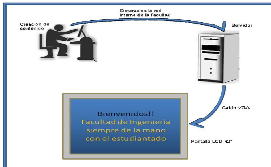
Estructura física de instalación de equipos para la implementación de Carteleras Digitales
